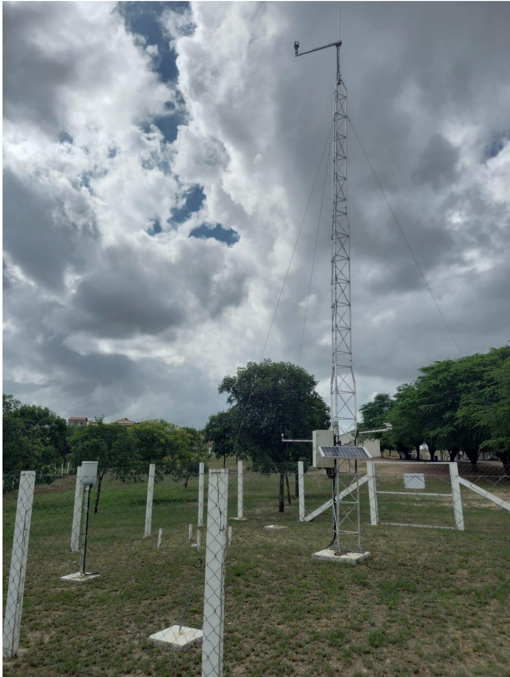
Figura 42. A Estação Agroclimática 2: fornece dados meteorológicos que auxiliam no desenvolvimento de experimentos na área de produção animal e vegetal
